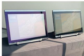
Izquierda: Sin unión óptica, 500 cd/m<sup>2</sup> (con cristal protector) / Derecha: Con unión óptica, 350 cd/m<sup>2</sup> (con cristal protector)
